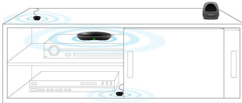
2. Connectez les mini-relais infrarouges aux ports situés à l'arrière du hub Harmony.
