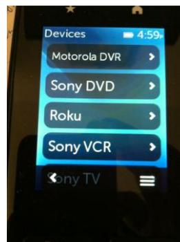
**ATTENTION :** Ne mettez pas hors tension ou ne changez pas les entrées de votre dispositif lorsque vous êtes dans le mode Dispositif. La télécommande n'effectue pas le suivi des changements d'état dans le mode Dispositif. Vous pouvez régler les paramètres de son ou d'image, etc., mais ne mettez pas sous ou hors tension les dispositifs ou ne changez pas les entrées.
