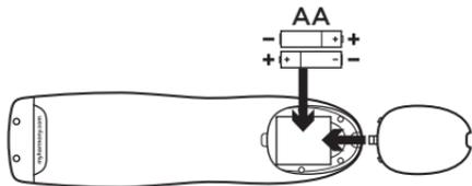
Insérez les deux piles AA (fournies) dans le compartiment à piles.
