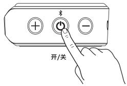
1. 请注意: 为节省电量, X50 将在蓝牙连接断开 15 分钟后自动关闭。
