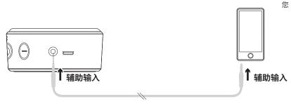
也可以通过 3.5 毫米的辅助连接线将 X50 与任何其他音源设备连接。
