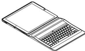
2. キーボード側のiPad Proの端を持ち上げ、くぼみ近くのホルダーの端を押し下げてiPad Proを外します。
