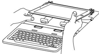
2 将平板电脑托架平放下来，上推平板电脑，将平板电脑下沿从托钩中取出：
