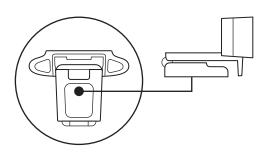
**2** 将三脚架拧入 1/4 英寸安装螺纹,将网络摄像头固定于三脚架上。
