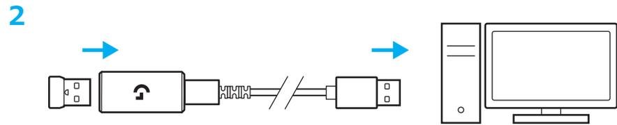
※エクステンダーを使用し、USBレシーバーとキーボード本体の物理的な距離を縮める事で、より安定したワイヤレス接続性が確保できます。
