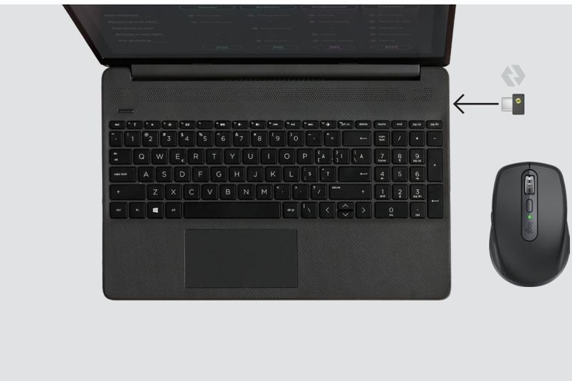
Zur Minimierung von Störungen durch WLAN-Netzwerke wird empfohlen, den Logi Bolt Empfänger auf derselben Seite wie die Maus anzuschließen, um die räumliche Entfernung zwischen der Tastatur, der Maus und dem Empfänger zu verringern.
