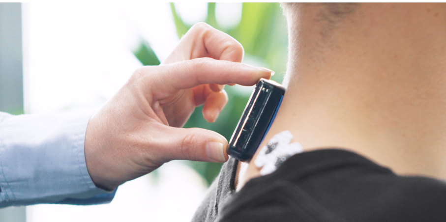
Zur Messung von Effekten auf die Körperhaltung durch externe Mäuse, The Logi Ergo Lab
