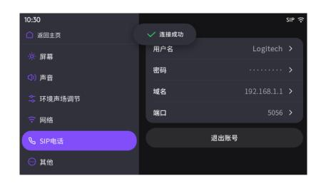
·SIP 电话注册成功,设备会显示"连接成功",同时右上角显示 SIP 图标。
