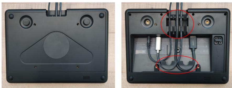
Figura 6: Logitech Tap: espacio para cables en la parte posterior del dispositivo
