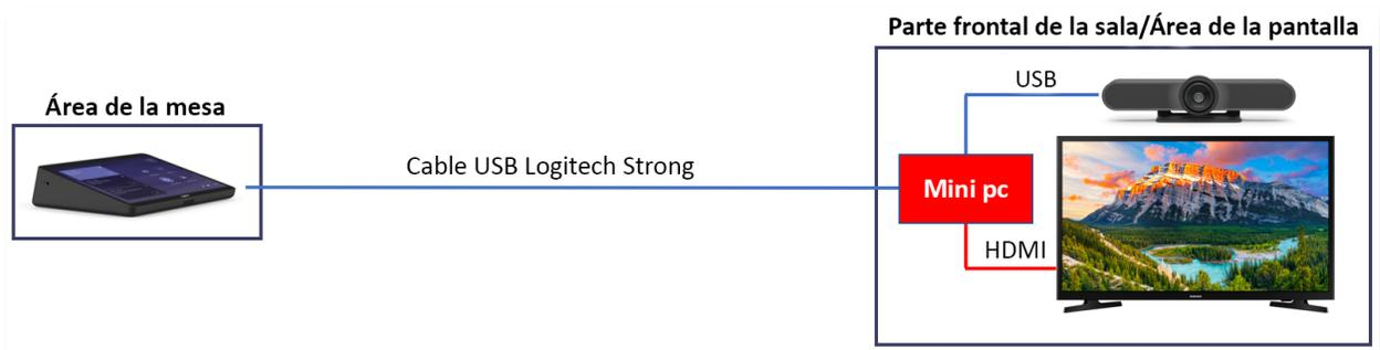
Figura 4: Solución Logitech para salas de reuniones pequeñas: diagrama de instalación (incluye Logitech Tap y MeetUp)
