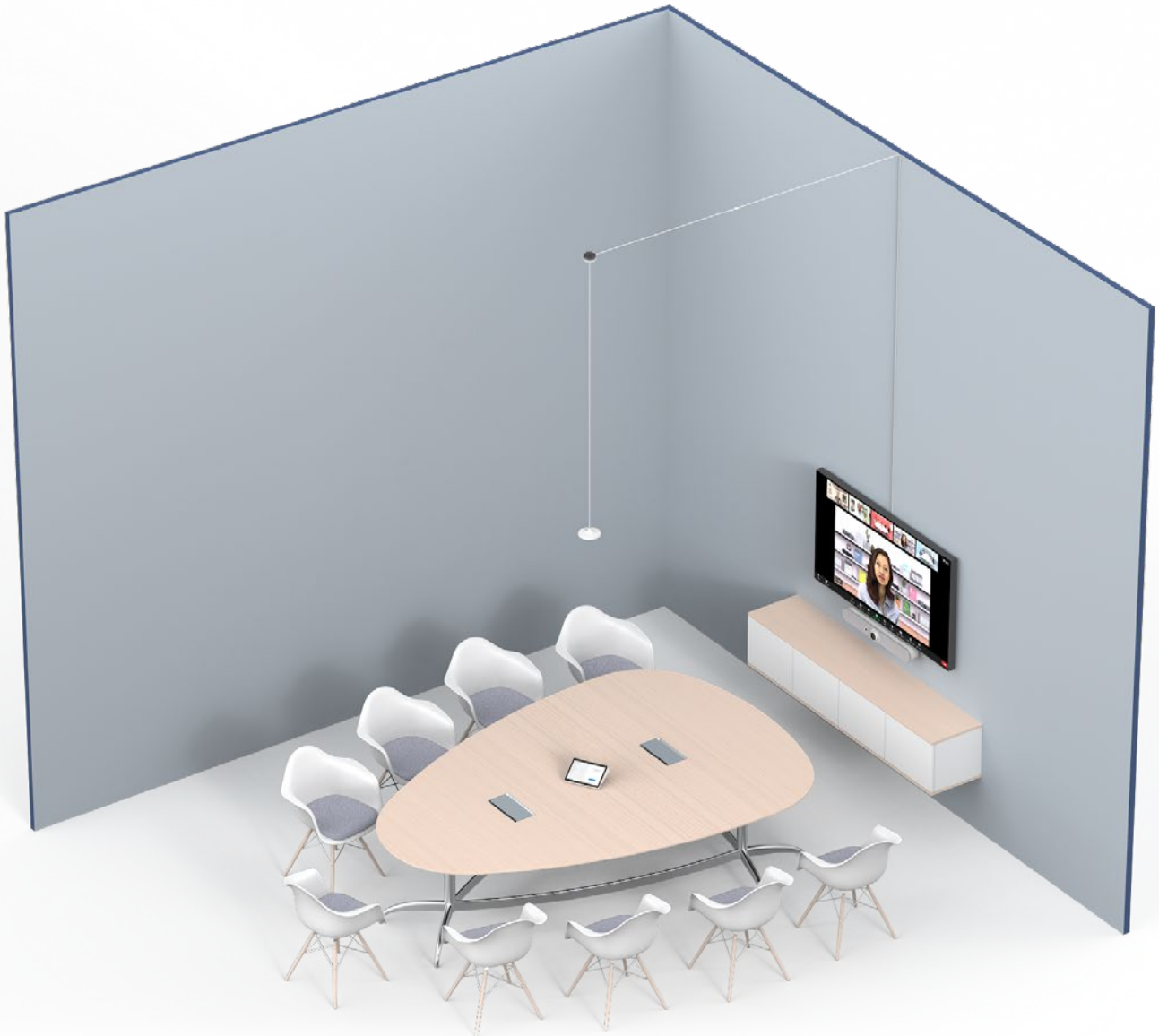
Figura 1: un micrófono con un soporte colgante. En esta imagen, el cable del micrófono está conectado a un cable de extensión de micrófono, que a su vez está conectado al Rally Bar Mini debajo del televisor. Nota: la imagen no está a escala.
