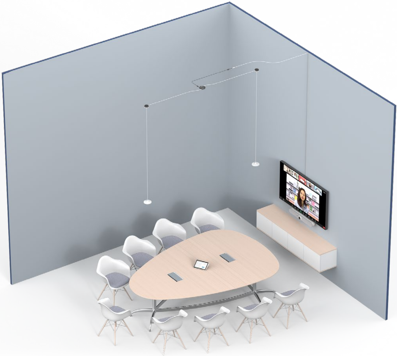
Figura 2: dos micrófonos con soporte colgante. Ambos micrófonos están conectados a un hub de micrófono y a su vez, el hub de micrófono está conectado a un cable de extensión para micrófonos Rally. Los micrófonos están a 2,4 metros de distancia el uno del otro, con el hub de micrófono en el medio para optimizar el uso del cable. Nota: la imagen no está a escala.
