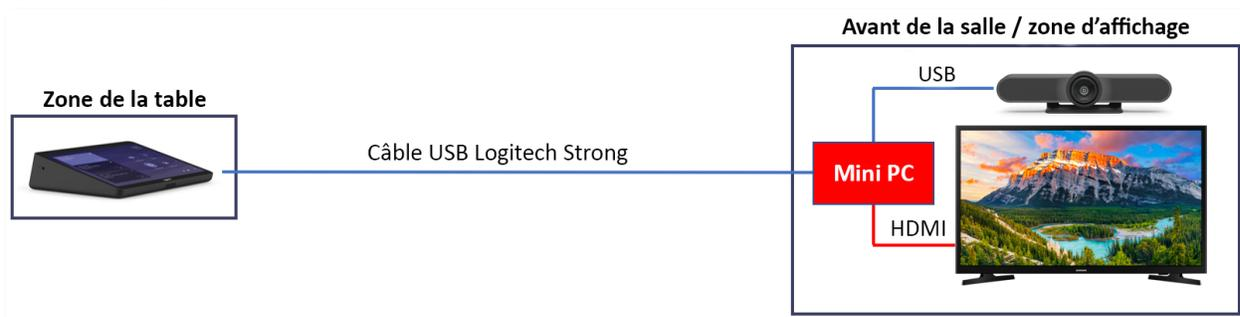
Figure 4: Solution Logitech pour salles de petite taille – Schéma d'installation – Inclut Logitech Tap et MeetUp
