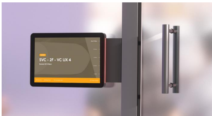
Figure 4: Logitech Tap Scheduler — Installation sur un cadre de porte
