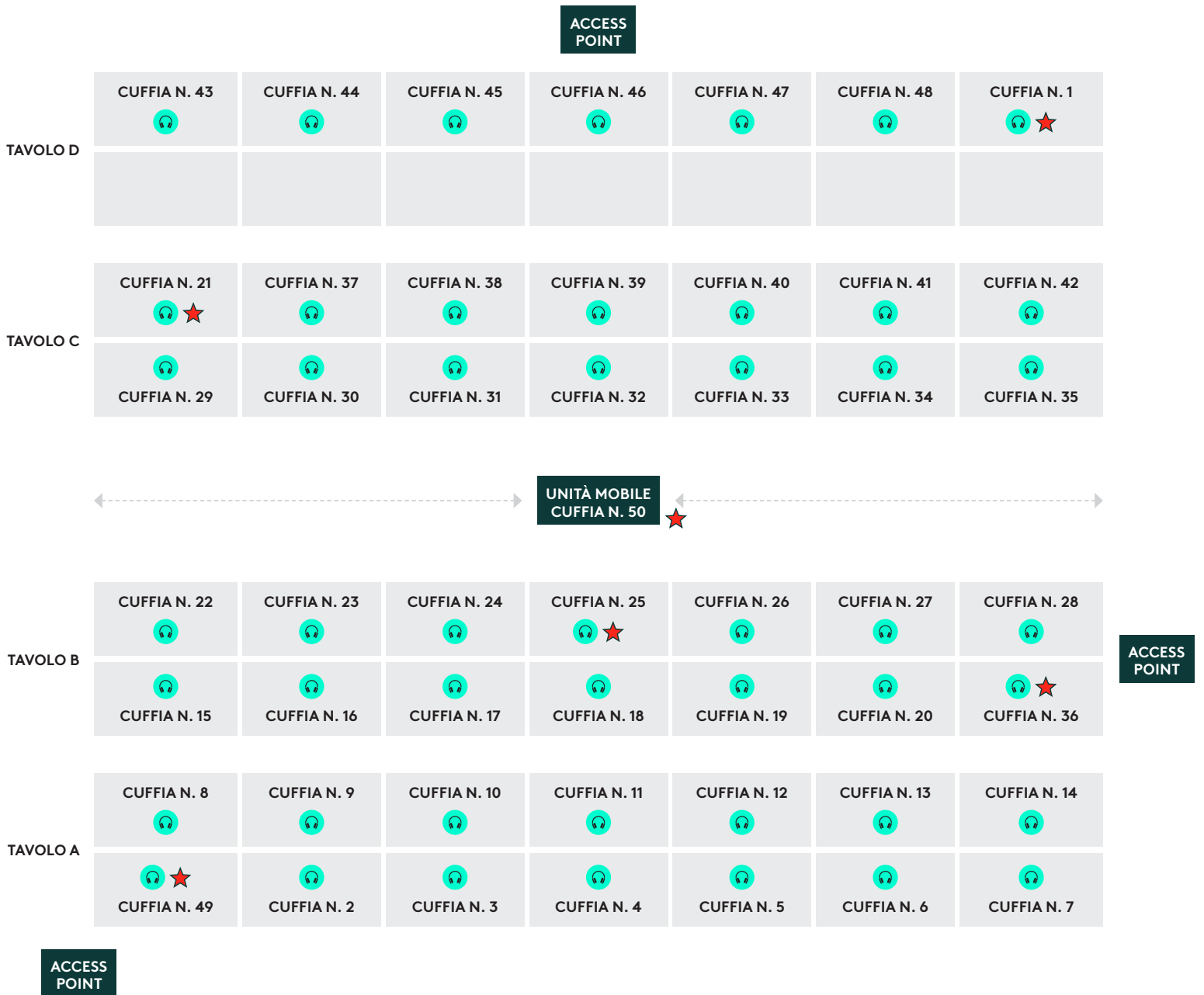
Schema della configurazione utilizzata per l'ambiente di test "stress estremo". Vedi le fotografie a pagina 6.
