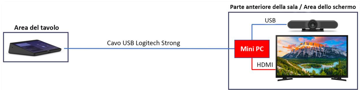
Figura 4: Soluzione Logitech per piccole sale – Diagramma di installazione – Include Logitech Tap e MeetUp
