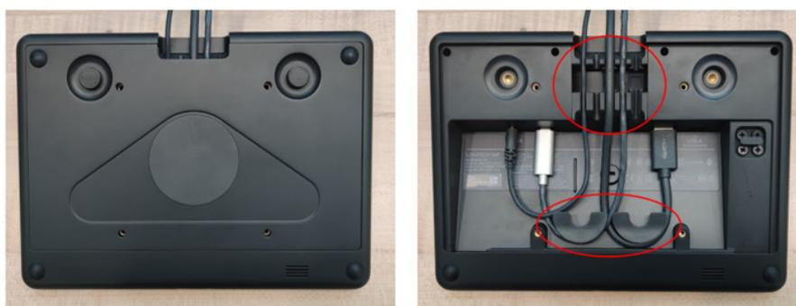
Figura 6: Logitech Tap – pozzetto per cavi incassato nel retro del dispositivo
