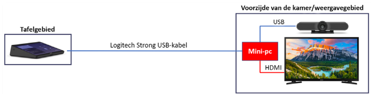
Afbeelding 4: Logitech oplossing voor kleine ruimtes; installatiediagram; inclusief Logitech Tap en MeetUp
