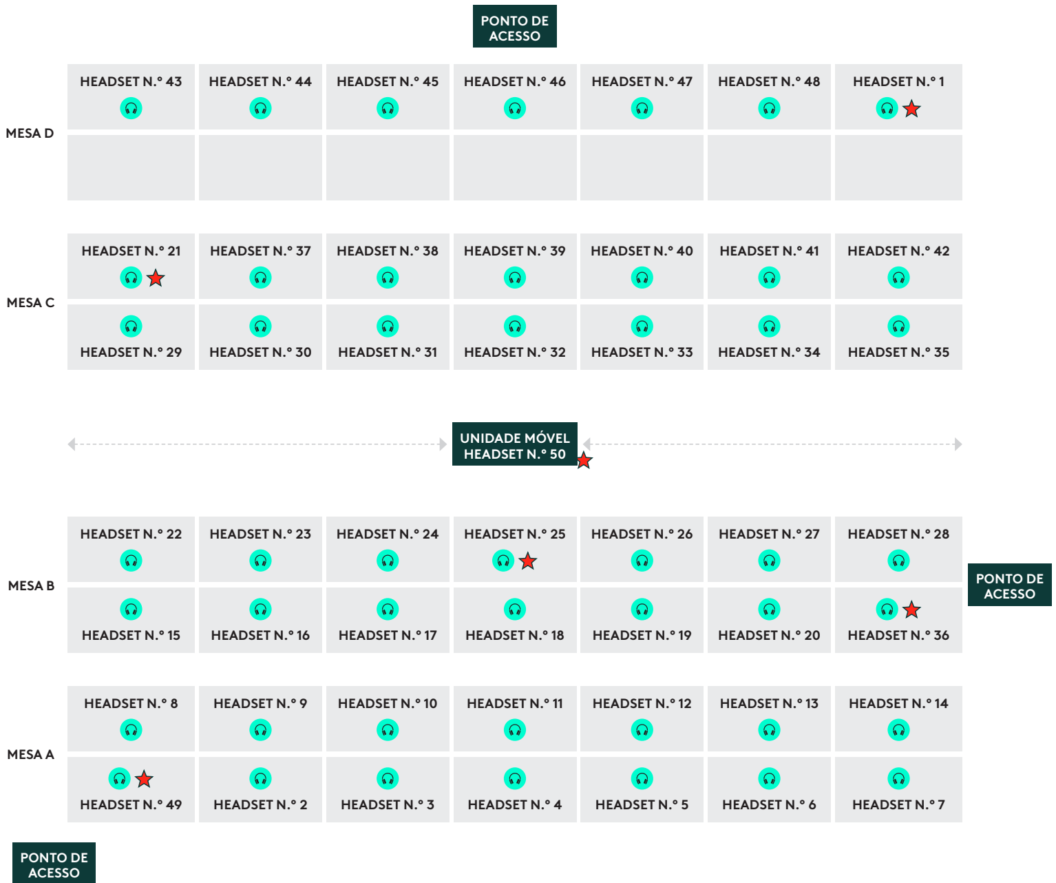
Diagrama esquemático da configuração para o ambiente de teste de "estresse extremo". Veja as fotos na página 6.
