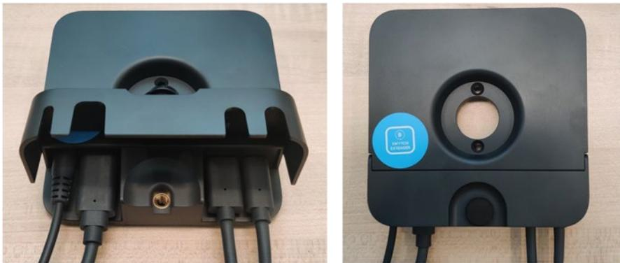
Figura 7: Extensor do Logitech Swytch – Área de cabeamento embutido com alívio de tensão de cabos integrado
