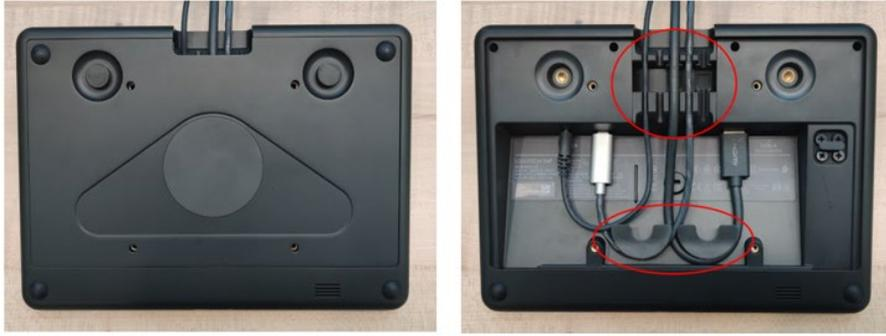
Figura 6: Logitech Tap – Área de cabeamento embutido na parte traseira do dispositivo
