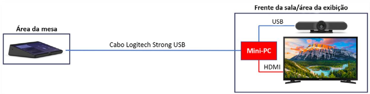
Figura 4: Solução Logitech para Salas de Reunião Pequenas – Diagrama de instalação – Inclui o Logitech Tap e MeetUp
