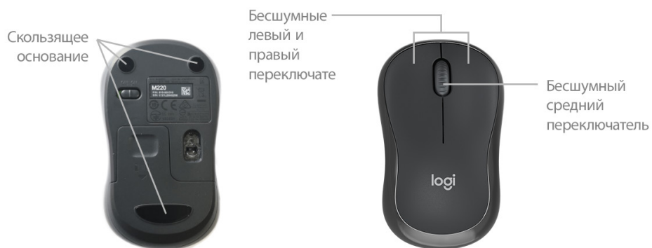
Рисунок 5. Мышь Logitech M220, вид снизу и сбоку
