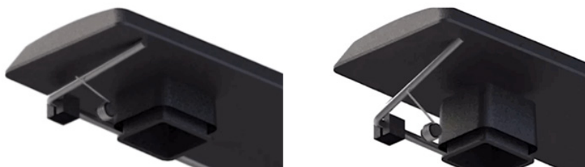
Рисунок 4. Конструкция с торсионной пружиной снижает шум, обеспечивая плотное прилегание балансировочного стержня к колпачку
