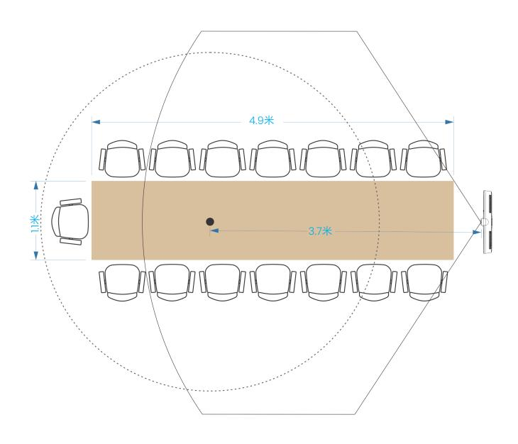
每只额外的麦克风应相距 2.4 米,这样可提供最佳的重叠覆盖范围。如果使用 CC5000e 麦克风安装配件,还会发现这是麦克风线缆长度所确定的间距。
