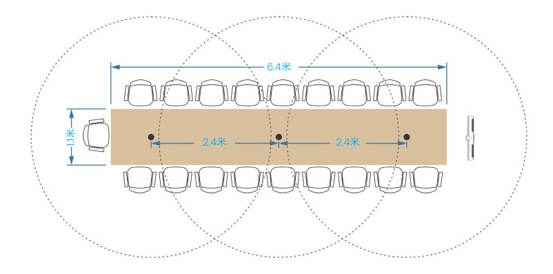
在 U 形会议桌配置中,麦克风的安装位置偏向于会议室的前部,以确保适当覆盖最靠近会议室前部并面向摄像 头的人员。同样,麦克风的间距不应超过 2.4 米。
