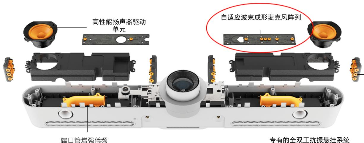
图 12：罗技 CC5500e – 音频系统的组成部分
